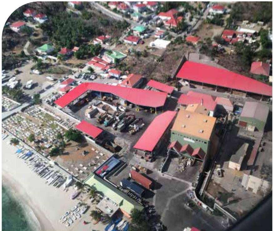
●●● La planta tenía que ser ultramoderna y, a la vez, resistente a las inclemencias meteorológicas. «Diseñamos una planta capaz de resistir terremotos y ciclones. Las estructuras, los cimientos de hormigón, todo tenía que ser más grueso. Cuando el huracán Irma devastó la isla en 2017, la central se paró y el personal local consiguió volver a ponerla en marcha en menos de tres días», cuenta **Stéphane Bertrand**, director de Desarrollo de Paprec Energies.
