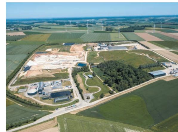
Paprec investiert in seine Produktionsanlagen, die auf eine Begrenzung des Anteils an deponiertem Endmüll abzielen. Viele Lagereinrichtungen für ungefährliche Abfälle sind daher mit Anlagen zur organischen Verwertung (Lebensmittelabfall-Entpackungsmaschinen- und Biogaserzeugungsanlagen) oder zur Gewinnung von Ersatzbrennstoffen (EBS) verbunden.
