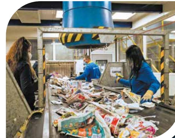
**Der Standort Calce** umfasst auch ein Sortierzentrum für Abfälle aus getrennter Sammlung. Sortierreste werden der Energierückgewinnungsanlage zugeführt.
