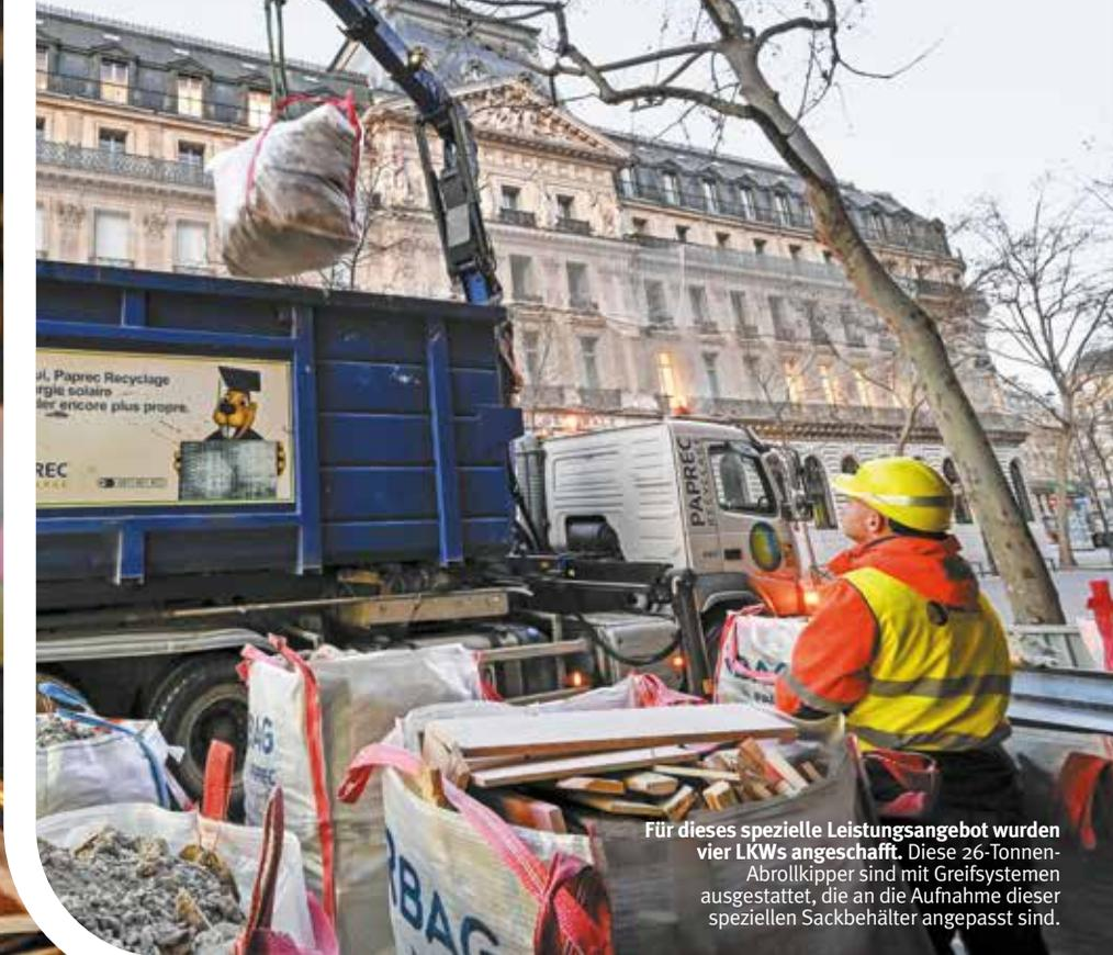
Für dieses spezielle Leistungsangebot wurden vier LKWs angeschafft. Diese 26-Tonnen-Abrollkipper sind mit Greifsystemen ausgestattet, die an die Aufnahme dieser speziellen Sackbehälter angepasst sind.
