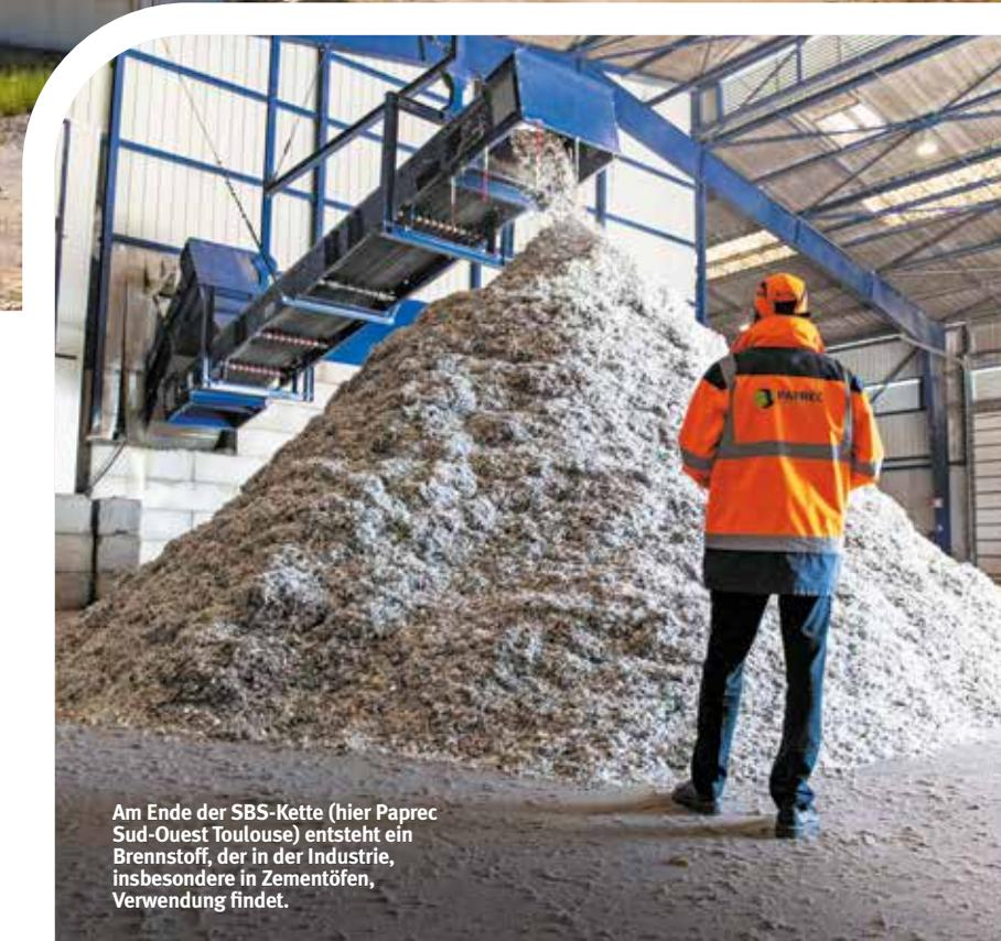
Am Ende der SBS-Kette (hier Paprec Sud-Ouest Toulouse) entsteht ein Brennstoff, der in der Industrie, insbesondere in Zementöfen, Verwendung findet.
