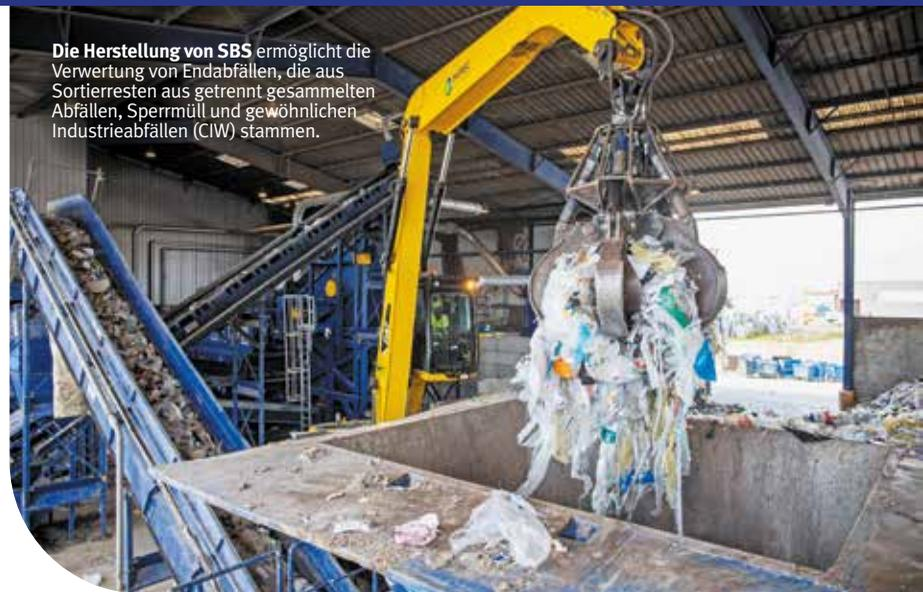
Die Herstellung von SBS ermöglicht die Verwertung von Endabfällen, die aus Sortierresten aus getrennt gesammelten Abfällen, Sperrmüll und gewöhnlichen Industrieabfällen (CIW) stammen.
