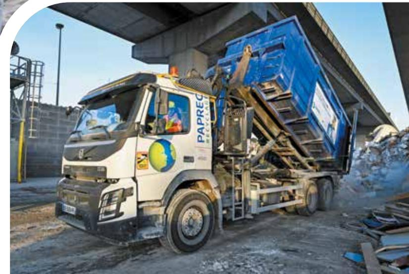
Die 1-Kubikmeter-Behälter, die bis zu 1,5 Tonnen Bauschutt aufnehmen können, werden am Zielstandort entleert. Dann werden die Abfälle zur Verwertung sortiert.
