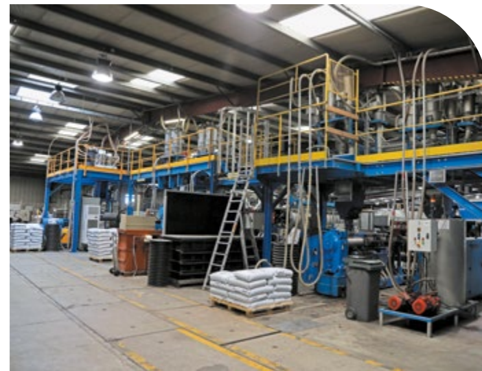
Dans l'usine, trois lignes de fabrication sont consacrées aux tubes de 300 mm à 1 200 mm de diamètre.
