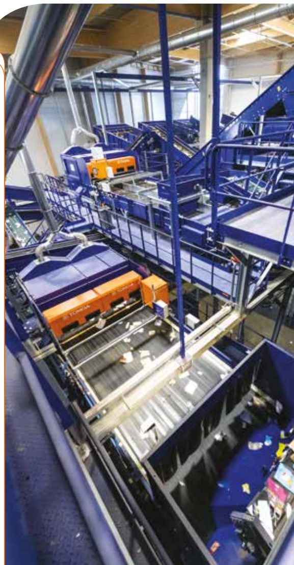
Les trieurs optiques sont des outils technologiques essentiels pour atteindre l'objectif de 95 % de taux de valorisation des matières.
